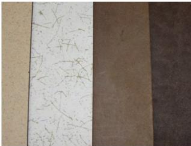
Figuur 3 Labschaal vezelplaatmateriaal op basis van kokosbolster [22]
