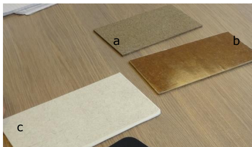
Figuur 7 Drie vormen van natuurvezelcomposieten (a) natuurvezelcomposiet uit vlas, zonder extra toevoegingen (b) composiet sandwich met isolatiemateriaal (c) composiet met toevoeging van witte kleurstof.
