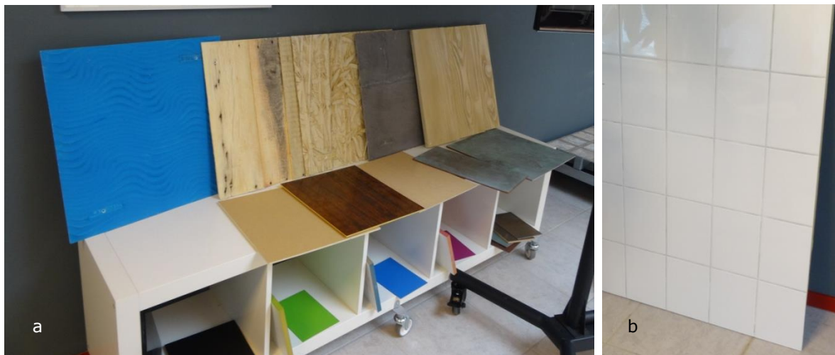
Figuur 10 Composiet met het uiterlijk van (a) hout en (b) tegeltjes.
