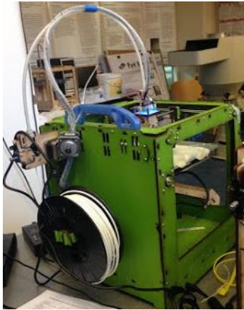
Figuur 31 De 3D-printer Ultimaker Original met verwarmde printplaat met PLA als biopolymeer.
