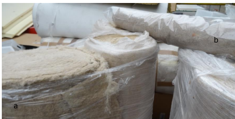
Figuur 8 (a) Vlas vezels en een kleine rol (b) glasvezels.
