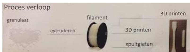
Figuur 32 Procesverloop van 3D-printing onderzoek.
