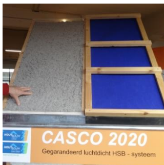
Figuur 23 Isolatie materiaal gemaakt uit kranten.
